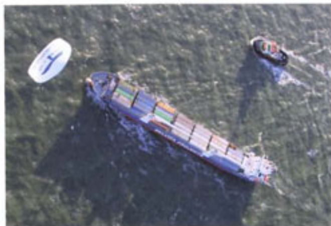
Frachter mit Windhilfsantrieb: Die Beluga SkySails wagt sich auf neues Terrain vor. Die Jungfernerreise klappte gut.
